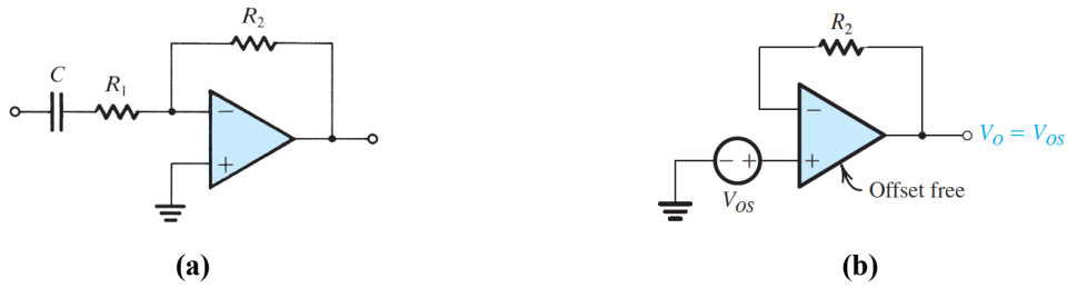
slika 1.5 (a) Kapacitivni coupling invertujućeg pojačavača; (b) Ekvivalentno kolo za određivanje DC izlaznog naponskog offset -a invertujućeg pojačavača.
